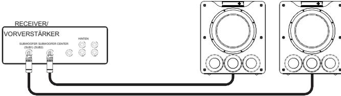
Sollten Sie mehr Subwoofer als Sub-Ausgänge von Ihrem AV-Receiver haben, bietet die Nutzung eines RCA-Splitters oder eines RCA-Y-Adapters eine einfache Lösung zur Teilung des Subwoofer-Ausgangs. Dies wird üblicherweise für einen Anschluss mehrerer Subwoofer bei nur einem Sub-Ausgang empfohlen.
