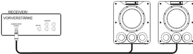
Eine weitere Möglichkeit ist die Nutzung der linken und rechten RCA- oder XLR-Ausgänge am PB-4000 für eine Verbindung von zusätzlichen Subwoofern in Reihe. Hier ist wichtig, passende Aus- und Eingangsklemmen zu nutzen. Wenn Sie beispielsweise RCA-Eingänge nutzen, stellen Sie sicher, dass auch RCA-Ausgänge für den Anschluss des nächsten Subwoofers in Reihe verwendet werden.
